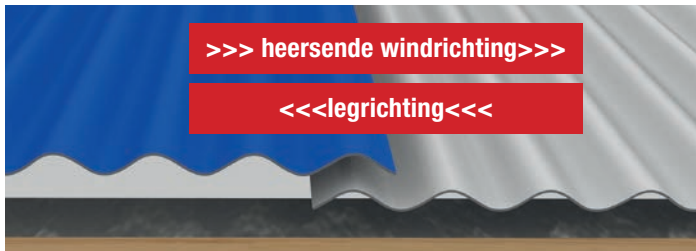
Doorsnee: voorbereiden van acrylaat lichtplaten
